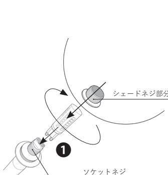
**!** ネジのかみ合わせに余裕がある設計のため、回転軸がずれないよう垂直に差し込み、スムーズに回転する位置でネジを締めでください。ネジのかみ合わせが斜めになると破損の原因となります。
